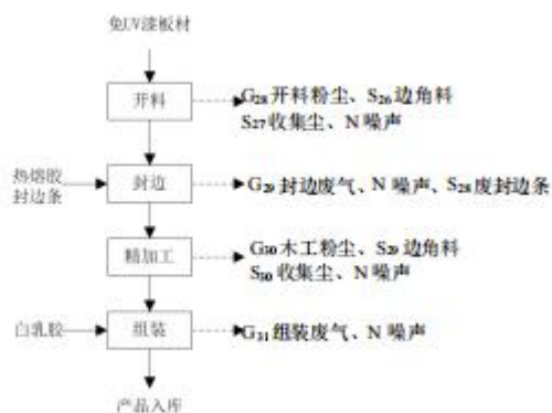
图 3-5 板式家具生产工艺流程图
